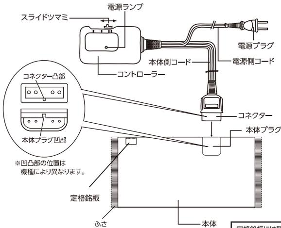
⚠ コントローラーやコード類はこの製品専用です。絶対に他の製品に使用しないでください。コントローラーが故障している場合、本体も故障している可能性があります。別のコントローラーを差替えて使用しないでください。
