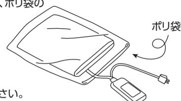
3. ポリ袋内側の空気を抜き、端をセロハンテープで止めてください。
